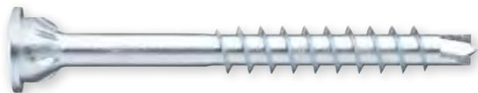
Vite a filetto parziale con testa autosvasante ridotta con bordino e alette svasatrici sottotesta per un fissaggio anche senza spazi vicino ai bordi. Particolarmente idonea per listelli fermavetro o battiscopa in qualsiasi tipologia di ambiente grazie ai diversi rivestimenti possibili.
