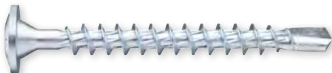
Vite a filetto intero con geometria appositamente adattata per pannelli MDF (fibra di legno a media densità). Non necessita di prefatura, con testa mezza tonda "fissaschienali", filetto ottimizzato e punta auoforante extra lunga, è ideale per il fissaggio degli schienali in pannelli MDF, anche in testata, senza fessurazione o rigonfiamento.
