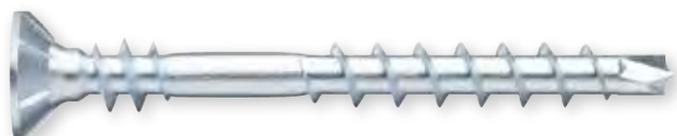
Vite a filetto parziale, con filettatura anche sottotesta e testa autosvasante (avvita e svasa) ad elevato effetto di serraggio, per il fissaggio senza spazi vuoti e senza preforatura di pannelli in legno. Il filetto sottotesta permette assemblaggi senza scheggiature anche di pannelli in legno leggero e avvitiamenti perfettamente a filo.
