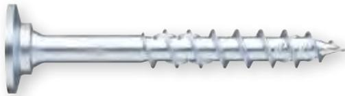
Vite a filetto parziale con testa piana larga per il fissaggio di giunzioni legno-legno, a filo ed anche con valori elevati di resistenza, in costruzioni in legno. E' idonea per applicazioni in ambienti interni.
