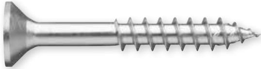
Vite a filetto parziale in acciaio inox speciale 1.4529 a resistenza alla corrosione molto alta con testa piana svasata per il fissaggio di giunzioni legno-legno in aree costantemente esposte a corrosione molto elevata, quali piscine (classe di resistenza alla corrosione V).
