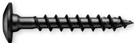
Vite a filetto intero, con testa larga bombata e gambo rinforzato sottotesta, per il fissaggio di elementi piatti in acciaio, quali bandelle, su legno. Il particolare rivestimento zinco-nichel nero conferisce un'elevata resistenza alla corrosione (500 h in nebbia salina).
