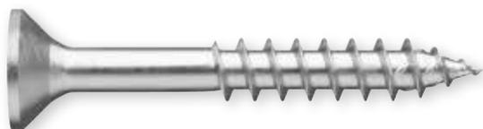
Vite a filetto parziale in acciaio inox speciale 1.4539 ad alta resistenza alla corrosione con testa piana svasata per il fissaggio di giunzioni legno-legno in aree esposte a corrosione elevata (classe di resistenza alla corrosione IV).
