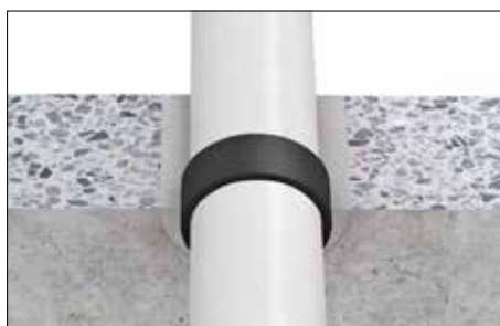
A solaio: applicazione del nastro solo a filo del lato inferiore del solaio (all'interno del solaio)
