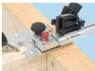
7. Ruotare la dima di 180°, affondare completamente la vite
