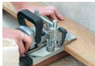
Fresare con la fresatrice per lamelle sul punto marcato.
