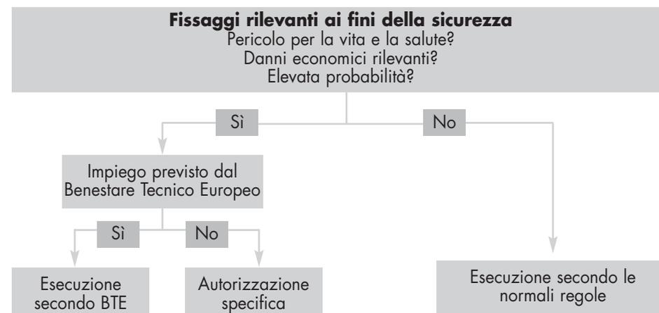
Fig. 10.2: regole per l’esecuzione di un fissaggio
