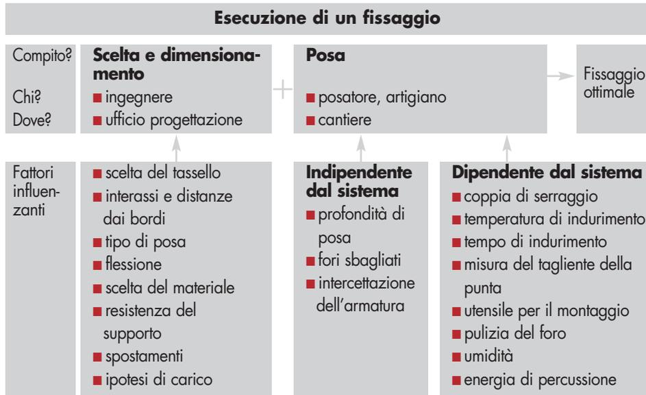
Fig. 13.2: fasi dell'esecuzione di un fissaggio e fattori influenzanti
