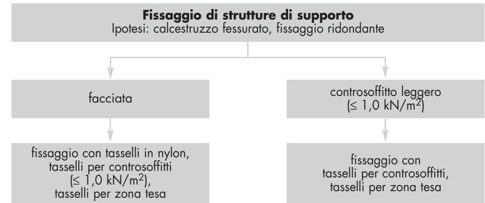
Fig. 10.6: tasselli per strutture di supporto
