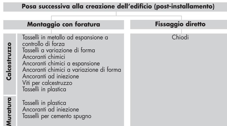
Fig. 2.3: sistemi di fissaggio su strutture preesistenti
