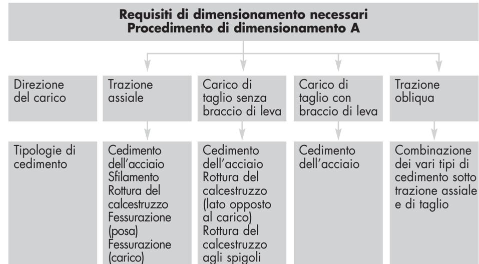
Fig. 11.11: requisiti di dimensionamento necessari col procedimento di dimensionamento A
