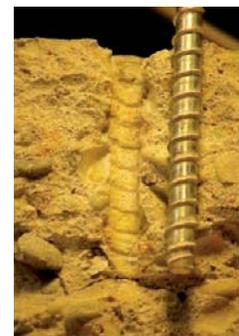
Fig. 5.13: ancorante a vite e una filettatura tagliata nel calcestruzzo [50]
