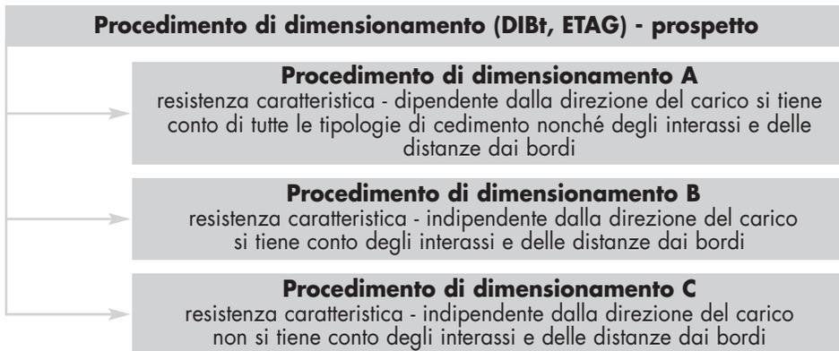
Fig. 11.9: caratterizzazione dei procedimenti di dimensionamento A, B e C e della direttiva per il dimensionamento del DIBt e dell'ETAG
