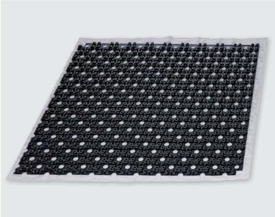
Pellicola di colore nero in PS da 1 mm di spessore. Le dimensioni: lungh. 1 m x largh. 1 m x alt. 13 mm. Le bugne permettono un rapido fissaggio del tubo RAP diametro 12 x 2 mm e sono predisposte a passo 5 cm (posa rettilinea) e a passo 7 cm (posa in diagonale).
