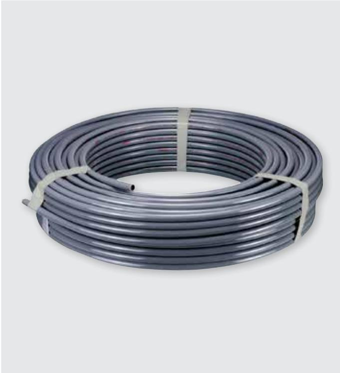
Il Tubo per la realizzazione di impianti a pannelli radianti, in polietilene reticolato PE-Xa (polietilene ad alta densità reticolato secondo il metodo "A" con perossidi), rivestito esternamente con pellicola in EVOH (alcol etilvinilico) che rende il tubo impermeabile all'ossigeno secondo DIN 4726.
