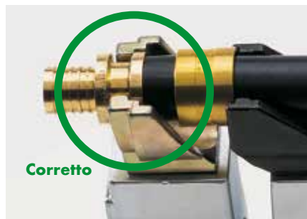
Posizionamento corretto della forcina F sul collare del raccordo con MSZ.
