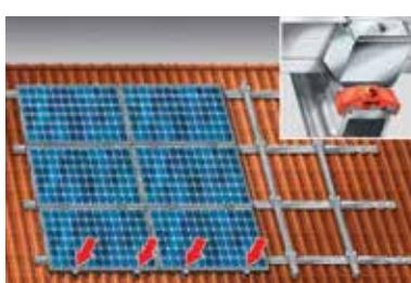
Nel caso di montaggio verticale dei profilati SOLAR, montare una graffa di arresto (coppia serraggio 15 Nm) dopo la graffa terminale. In questo modo si evita un eventuale slittamento della graffa terminale.
