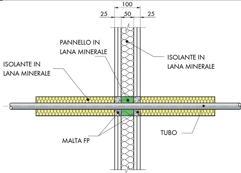
\*Isolamento di 600 mm di lunghezza min. richiesto per tubi Alupex
