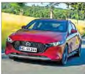
**Mazda** bringt den **Diesotto-Motor** in Serie: Als erster Hersteller bieten die Japaner ab Ende September zunächst im **Mazda 3** (im Bild) und später auch im CX-30 einen Benzinmotor an, der in bestimmten Betriebsituationen selbstständig zündet wie ein Diesel. Mazda führt das Prinzip als Skyactiv-X-Technologie ein. Sie soll das Beste aus 2 Welten kombinieren: Der Motor bietet das spontane Ansprechverhalten und die hohen Drehzahlen eines Benziners, aber das hohe Drehmoment und
