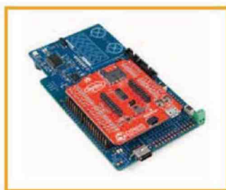
Fig. 2 – Lo shield add-on PSoC Pioneer IoT (scheda rossa) estende le capacità di schede Cypress Pioneer come il kit PSoC 6 BLE Pioneer (blu) con le sue opzioni di connettore multiplo per aggiungere schede di serie compatibili Qwiic e XBee (Fonte: SparkFun Electronics)
