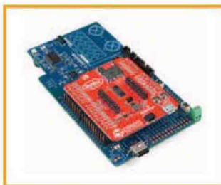
Fig. 2 – Lo shield add-on PSoC Pioneer IoT (scheda rossa) estende le capacità di schede Cypress Pioneer come il kit PSoC 6 BLE Pioneer (blu) con le sue opzioni di connettore multiplo per aggiungere schede di serie compatibili Qwiic e XBee (Fonte: SparkFun Electronics)
