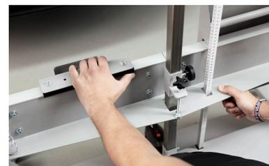
Regolazione del supporto laser (fino a 1,0 m) per la calibratura radar
