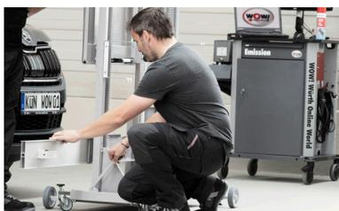
Sollevamento e abbassamento delle ruote di manovra con l'ausilio della leva di sollevamento, quindi semplicità di allineamento parallela al veicolo
