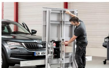
Impostazione del supporto scheda di calibratura (fino a 1,85 m, quindi per furgoni) per la calibratura con videocamera mediante la depressurizzazione a molla
