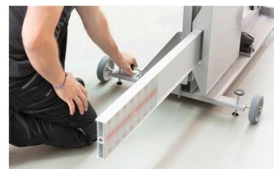
Regolazione semplice del carrello con una vite con manopola stellata (regolazione del parallelismo rispetto all'asse posteriore del veicolo)
